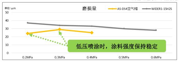
【喷涂条件】涂料: 原寿 HLP-8181/稀释比例: 涂料1 比 水1 (重量比)/喷涂开始温度: 230℃/喷涂距离: 200mm ※使用我司自制的落砂设备,在喷有100~120μm的涂料膜上落下1000克三河五号柱砂,测试涂料膜的磨损量。
