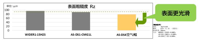
※ 表面细致,凹凸减少会导致通气性降低,对于通气性要求高的铸件请注意。
