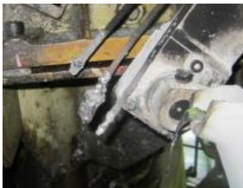
施工前, アルミ付着あり ADC12, 680°C
