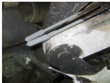
有涂料施工: 无铝液粘附 (运作2个班次后的照片) 1个星期无需维护
