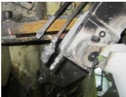
无涂料施工: 有铝液粘附 ADC12, 680°C
